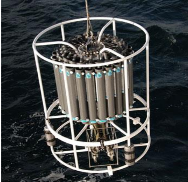
Gambar 2. CTD ( Conductivity, Temperature, and Depth ) Rosette adalah alat untuk mengukur dan menentukan sifat fisik penting dari air laut antara lain Konduktivitas, Temperatur dan Kedalaman laut. Alat ini memberikan gambaran yang tepat dan komprehensif dari distribusi dan variasi suhu air, salinitas, dan densitas yang membantu kita untuk memahami bagaimana pengaruh lautan terhadap kehidupan di dalamnya. Image courtesy of NOAA Okeanos Explorer Program, INDEX-SATAL 2010.
